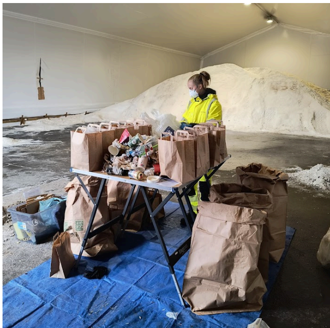
Figur 2: sorteringsoppsett under avfallsanalyse. Foto: Norwaste
